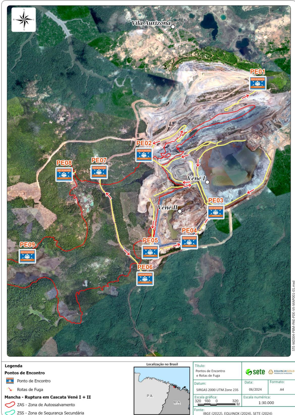
Figura 26 Pontos de Encontro e Rotas de Fuga instalados
