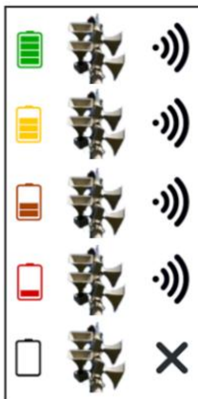
Figura 19 Ilustração representativa da queda de tensão da bateria e alcance sonoro constante
